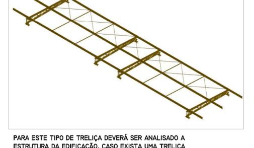
PARA ESTE TIPO DE TRILHA DEVERÁ SER ANALISADO A ESTRUTURA DA EDIFICAÇÃO, CASO EXISTA UMA TRILHA METÁLICA EXECUTADA NO LOCAL SERÁ REAPROVEITADA. TRILHA NÃO COTADA EM LISTA DE MATERIAL
